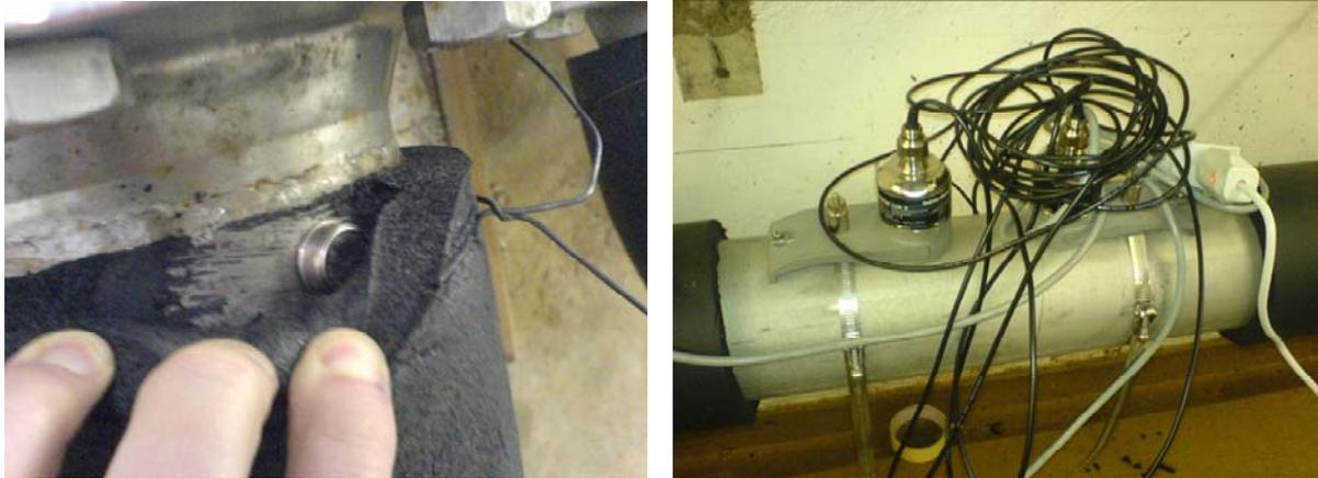
**Abbildung 31:** Temperatursonden (links) und Durchflussmessgerät (rechts).
