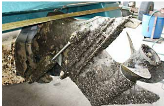
Fig. 2 : Moteur de bateau envahi par des moules zébrées au lac de Zurich (Photo : Nora Weissert).
