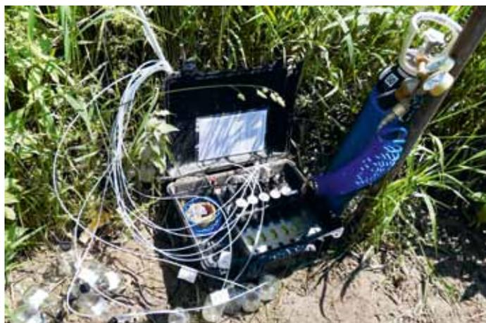
Abb. 4: Manuelle Probenahmen aus verschiedenen Tiefenhorizonten eines Grundwasserbrunnens.
