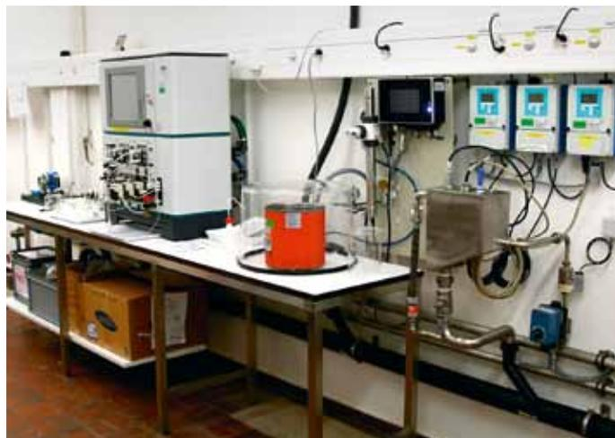
Abb. 5: Messraum mit der Online-Rohwasseranalytik.
