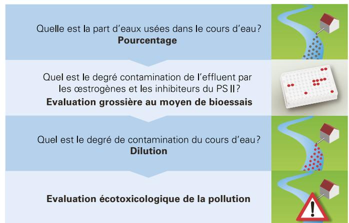
Etapes de la stratégie d'évaluation grossière de la qualité des eaux superficielles recevant des effluents d'épuration potentiellement pollués par des inhibiteurs du PS II et des œstrogènes.
