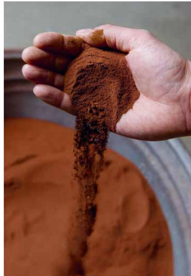
Phosphorhaltige Klärschlamm-Asche nach Verbrennung des zentral verwerteten Klärschlammes.
