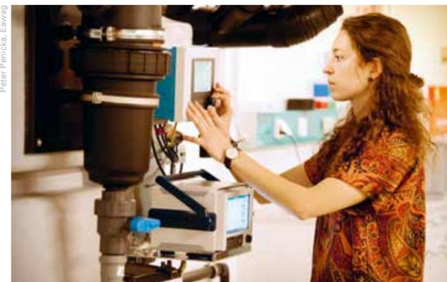
Bei der Urinbehandlung im Water Hub des Forschungsgebäudes NEST wird aus Urin ein konzentriertes, hygienisches Düngerprodukt erzeugt, aus dem selbst Mikroverunreinigungen entfernt werden.
