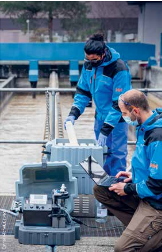
Prélèvement d'échantillons d'eau usée à la station d'épuration de Werdhölzli, à Zurich.
