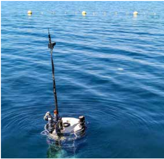
La sonde avec les capteurs pour des mesures automatiques en profondeur de la station de recherche («profilateur automatique multiparamètre»). (Sources: Minaudo et al. 2021, Wüest et al. 2021)
