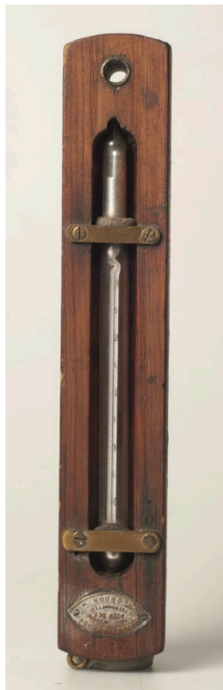
Thermomètre à renversement (1879)
