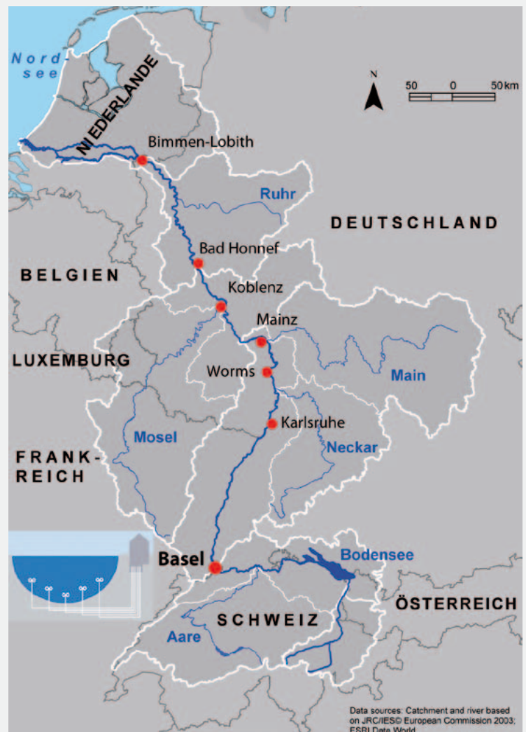
Fig. 1 Das Einzugsgebiet des 1230 km langen Rheins umfasst 200 000 km². Eingezeichnet sind die 7 Rheinmessstationen, die im Überwachungsnetz der IKSR zusammengeschlossen sind. Die RÜS bei Basel betreibt im Flussbett des Rheins fünf Entnahmestellen mit je doppelsträngigen Leitungen (Kunststoff und Stahl) für die Analytik von Metallen, Nährstoffen und organischen Spurenstoffen. Le bassin versant du Rhin, long de 1230 km, englobe 200 000 km². Sont tracées les 7 stations de mesure sur le Rhin, regroupées dans le cadre du réseau de surveillance de la CIPR. La SSR près de Bâle exploite 5 points de prélèvements dans le lit du Rhin, avec des conduites bi-tubes (plastique et acier) pour l'analyse de métaux, substances nutritives et éléments traces organiques.
