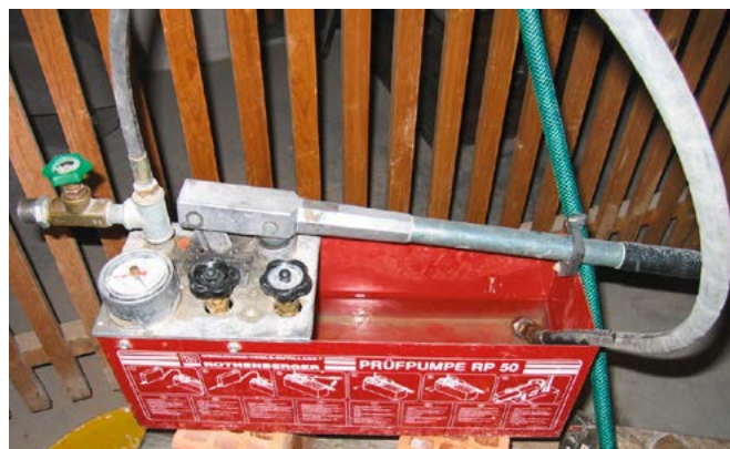
Fig. 2 Verunreinigte Schläuche und Gerätschaften, die zur Erstbefüllung, Dichtheits- und Festigkeitsprüfung verwendet wurden
