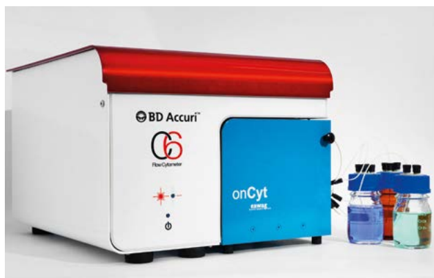
Fig. 1 Vollautomatisiertes Online-Durchflusszytometrie-System bestehend aus einem BD Accuri C6 Durchflusszytometer (rot/weiss) und dem selbst entwickelten Automations-Modul (blau)
