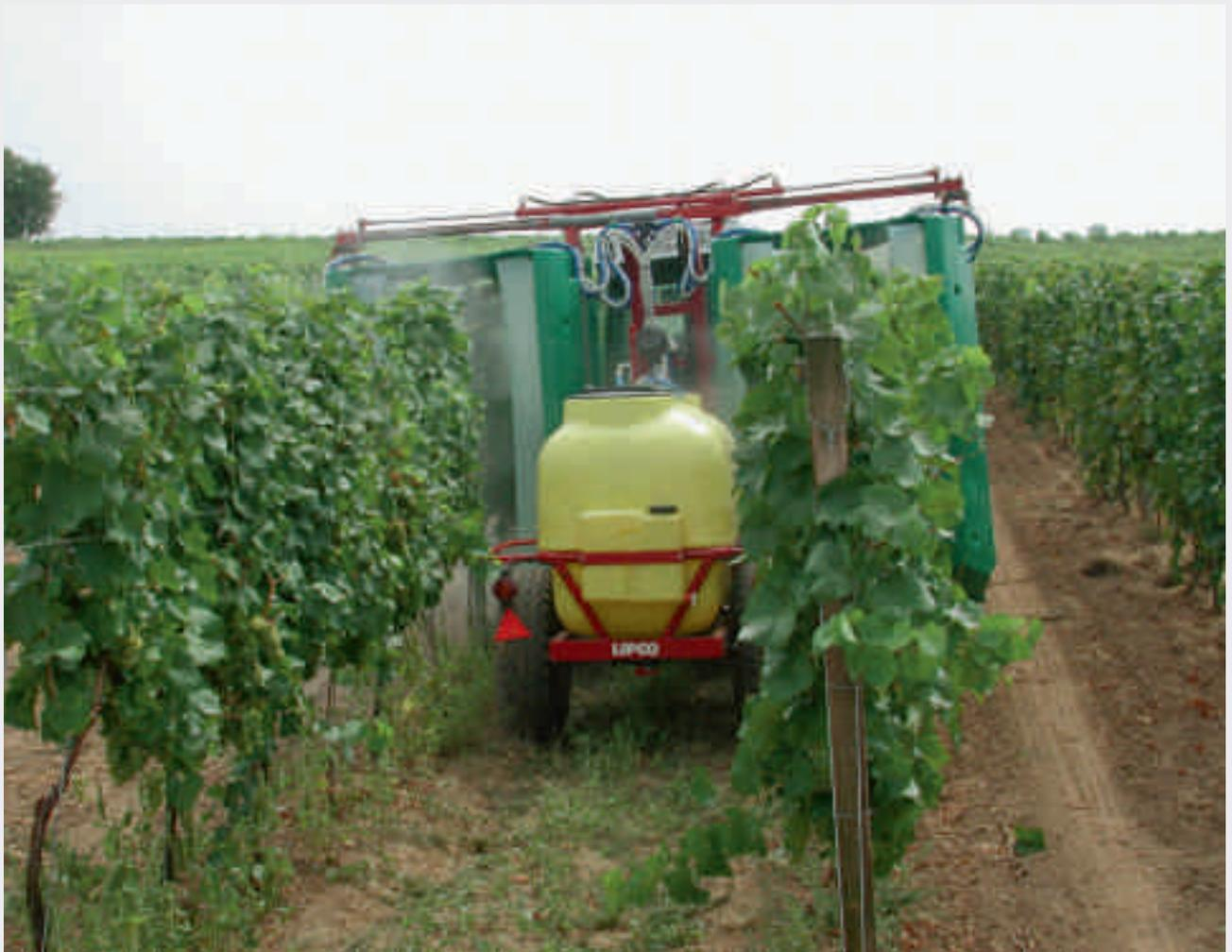
*Sprühverluste beim Ausbringen von Pestiziden lassen sich reduzieren, hier mit einem Tunnelspritzgerät im Rebbaun. (Foto: K. Bauer, CC-BY 3.0)*
