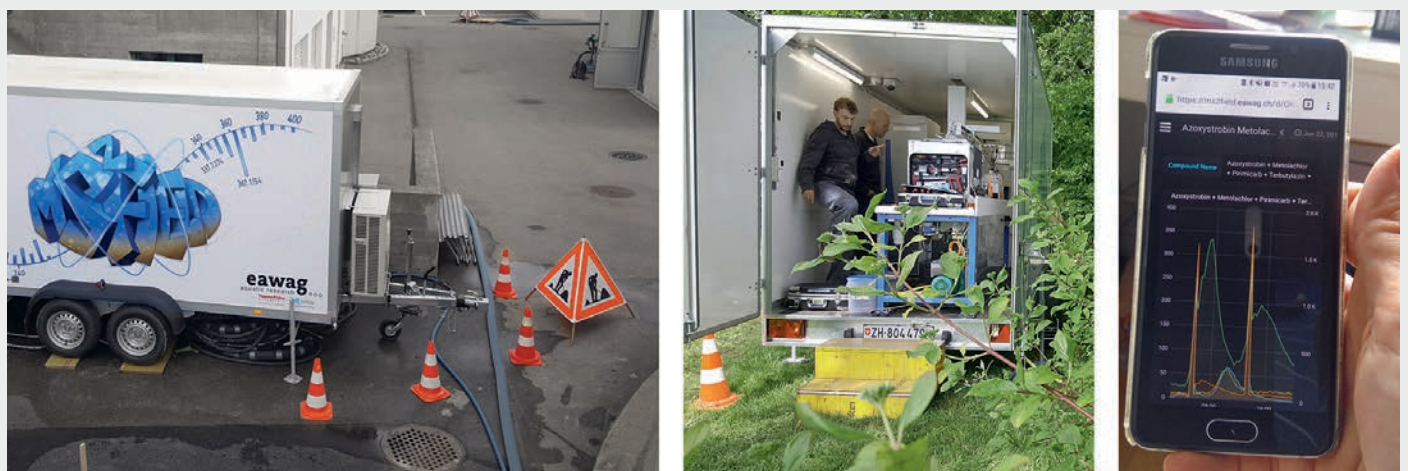
Fig. 1 MS 2 field-Anhänger auf der ARA Fehraltorf-Russikon (links), Blick in den Messanhänger (Mitte) und Live-Verfolgung der Daten auf dem Handy (rechts).
