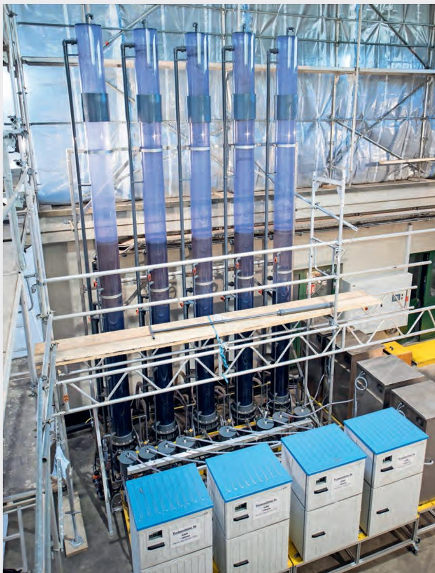
Fig. 4 Pilotanlage auf der ARA Glarnerland mit den mit Aktivkohle befüllten Versuchskolonnen und den Probennehmern im Vordergrund. (© Abwasserverband Glarnerland AVG)
