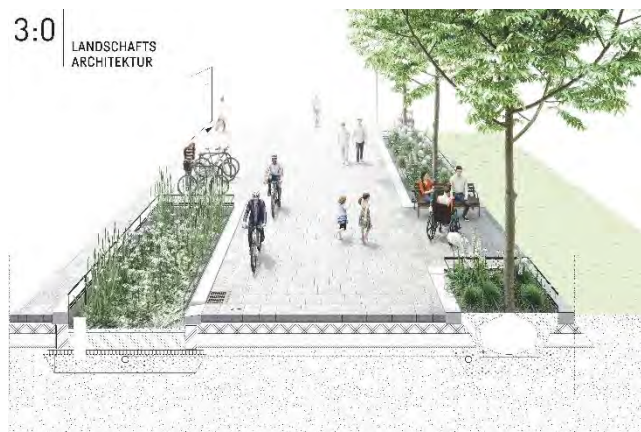
Abbildung 6: Schnittperspektive durch Duales Tiefbeet und Schwammstadtkörper
