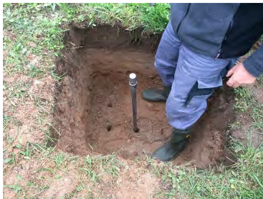
Abbildung 2: Entnahme von 9 Bohrstockproben aus 0.60 – 0.90 m Tiefe jeweils aus beiden Profilen
