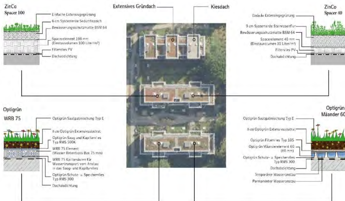
Abbildung 30: Luftbilder der Gebäude mit Gründachaufbauvarianten (Eigene Abbildung, © Luftbild: Geoportal des LGV Hamburg, © Aufbauvarianten: Optigrün international AG & Zinco GmbH).
