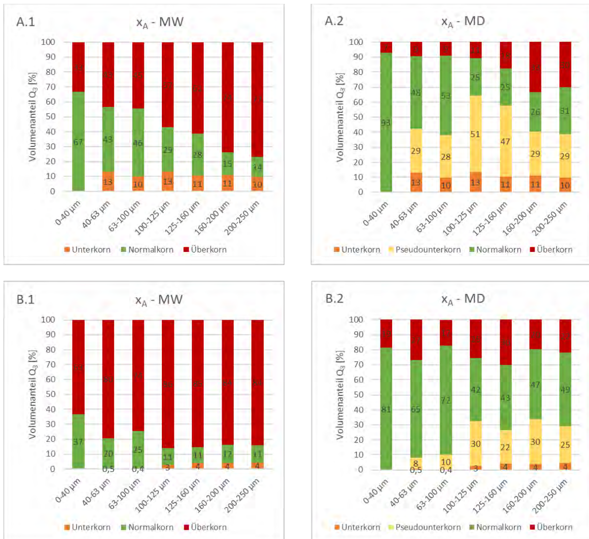
Abbildung 60 Normal-, Unter-, Pseudounter- und Überkornanteile der Einzelfraktionen S8 (A (oben): DIA dynamisch; B (unten): DIA statisch) beim 2D-Deskriptor x_A und der Auswertemethode nach Maschenweite (MW, links „1“) und Maschendiagonale (MD, rechts „2“)
