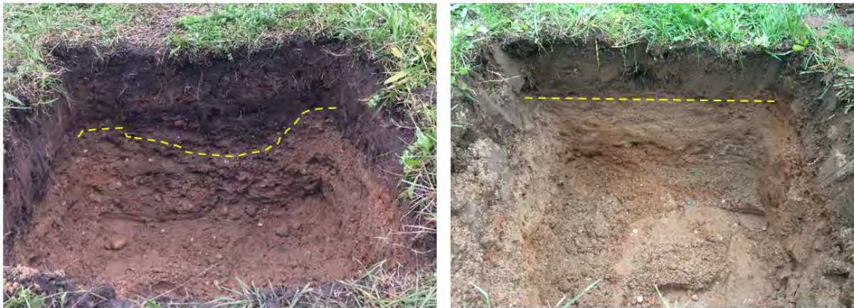
Abbildung 3: Bild (l) mit optisch erkennbarer Tiefenverlagerung 4 m vom Zulauf 2, während im Bild (r) in 50 m Entfernung ein trennscharfen Übergang in 0,30 m Tiefe vom Ober- zum Unterboden vorliegt
