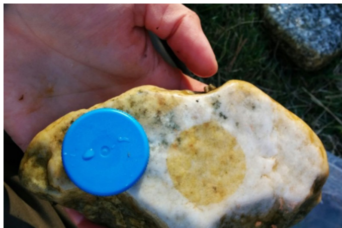
Abb. 3.6: Algenbewuchs-Probenahme von der Oberseite eines Steines. Die standardisierte runde Fläche wird abgeschabt.
