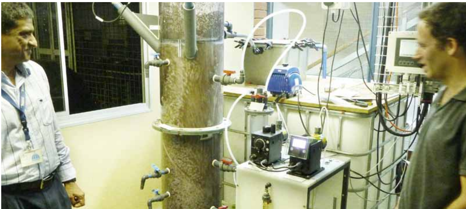
Fig. 6 : Pilote de traitement installé dans les locaux du service des eaux de Durban ouverts au public.
