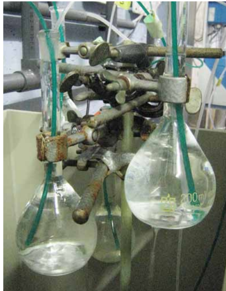
Abb. 2: Apparatur für die kontinuierliche Trichloramin-Messung an verschiedenen Stellen des Badewasserkreislaufs.
