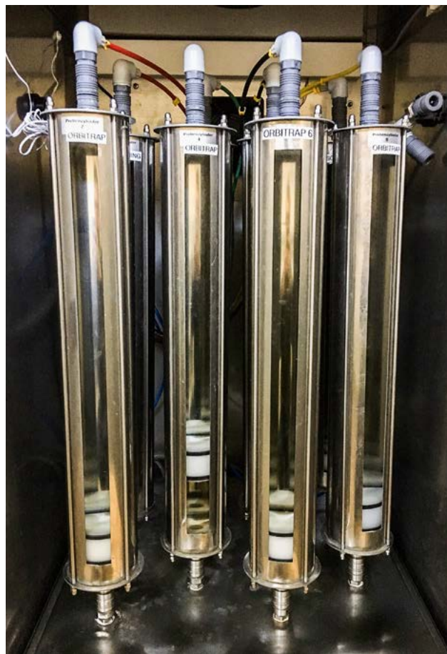
Fig. 5 Dieser Probenehmer wurde eigens für die HPLC-HRMS-Analytik entwickelt. Die kontinuierliche Probenahme erfolgt ohne Kontakt zur Umgebungsluft.
