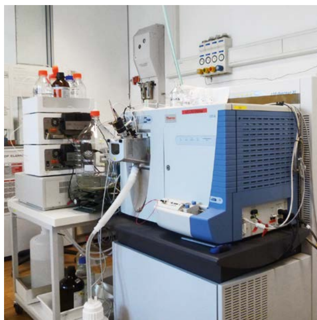
Fig. 6 An diesem HPLC-HRMS-Gerät werden die jeweils am Morgen gezogenen Sammelproben gemessen.
