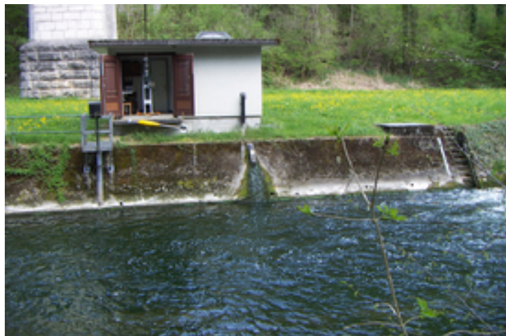
Station de prélèvement NADUF en bordure de la Glatt, à Rheinsfelden. (Photo : OFEV)
