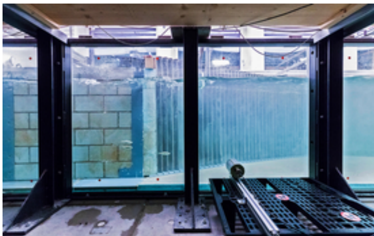
Des spiralins devant la grille de guidage CBR dans le dispositif expérimental du VAW. Le canal d'essai fait 30 m de long, 1,5 m de large et 1,2 m de profondeur. (Photo : VAW)
