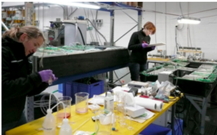
Des chercheuses examinent, sur la base de bioessais, l'efficacité de différents procédés de post-traitement pour l'élimination de produits de réaction instables et toxiques des eaux usées. (Photo: Centre Écotox)
