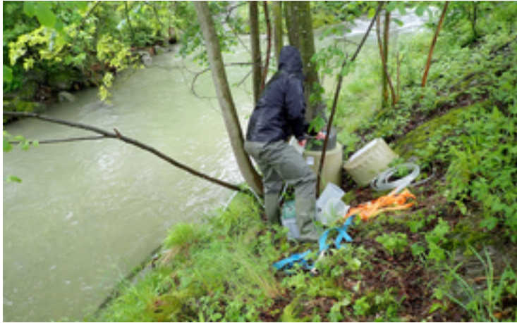
Déploiement d'un échantillonneur automatique au niveau du cours d'eau récepteur des eaux usées durant un événement pluvieux. (Source: Eawag)
