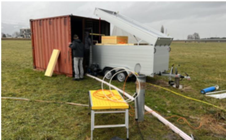
L'eau souterraine a été pompée et analysée à de tels puits sur le lit majeur.
