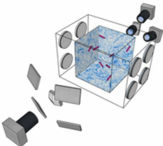
En laboratoire, des caméras enregistrent le mouvement des particules dans des boîtes de mesures transparentes remplies d'eau. Pour cela, les fibres sont plus efficaces que les sphères. (Graphique: Holzner Lab / Environmental
