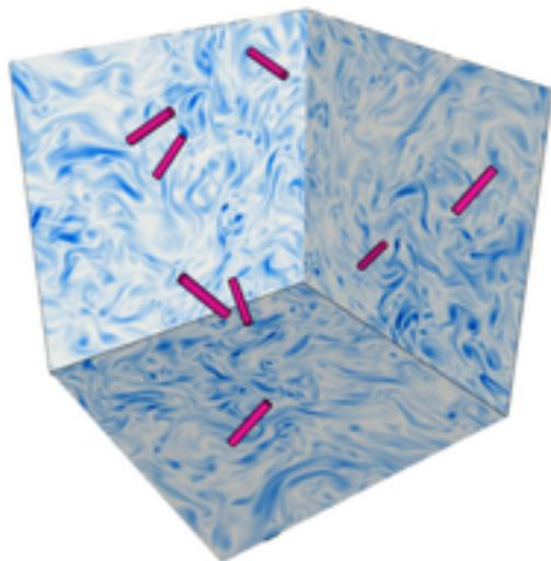
Avec la nouvelle méthode, il suffit de suivre les mouvements de quelques fibres rigides pour pouvoir saisir la dynamique complète des tourbillons. (Graphique: Holzner Lab / Environmental Fluid Mechanics – EFM)
