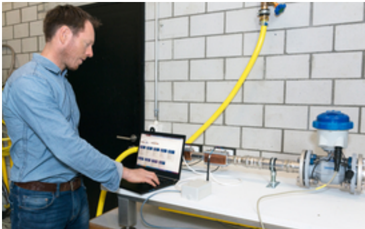
Le Dr. Frank Blumensaat (Département de la gestion des eaux urbaines) mesure avec Adawim le débit de l'eau dans le dispositif expérimental, en mode sans fil. (Foto: Patrick Cipriani / ZHAW)
