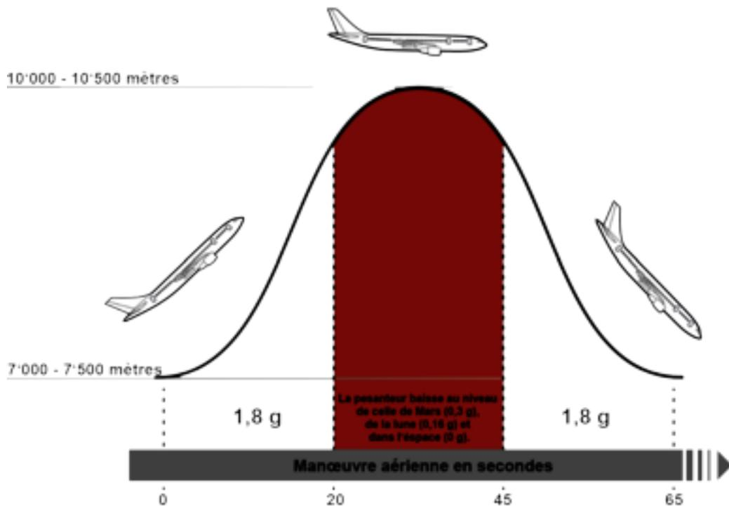
La pesanteur sur terre est de 1 g (soit  $9,81 \text{ m/s}^2$ ). Au cours d'un vol parabolique, il est toutefois possible de simuler une apesanteur de 0 à 1,8 g. (Graphique : Eawag).
