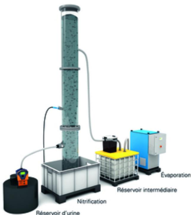
Fig. 2 : La technique de séparation et de traitement de l'urine mise au point dans le projet « Vuna » intervient également dans le projet « Water Hub ». Les urines collectées séparément sont transformées en engrais par un système de nitrification et d'évaporation. (Illustration : Eawag)
