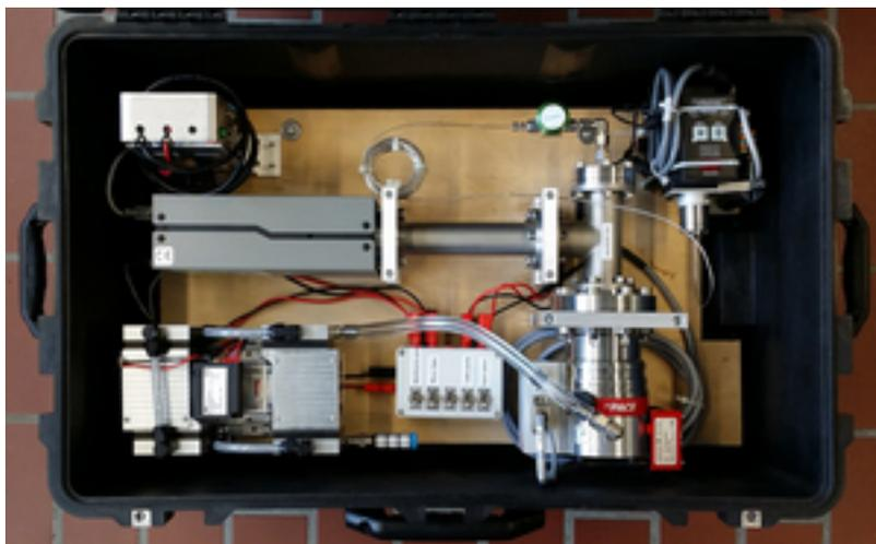
Le spectromètre de masse portatif dans sa valise à roulettes. En haut, au milieu : la trompe ou «Rüssel» enroulée, c'est-à-dire le capillaire avec lequel le gaz est aspiré.
