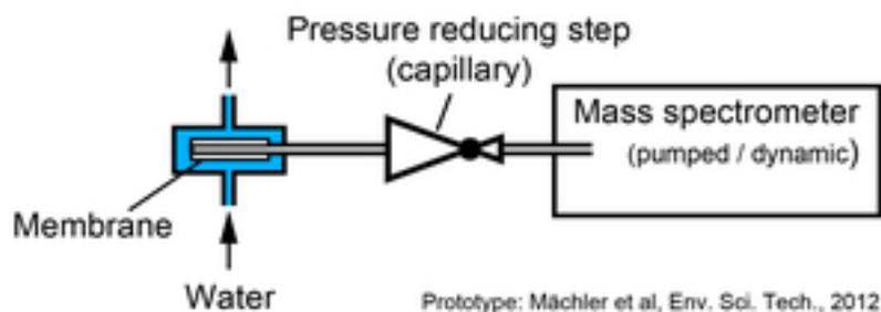
Principe du prélèvement de gaz en milieu aqueux basé sur une séparation membranaire préalable.
