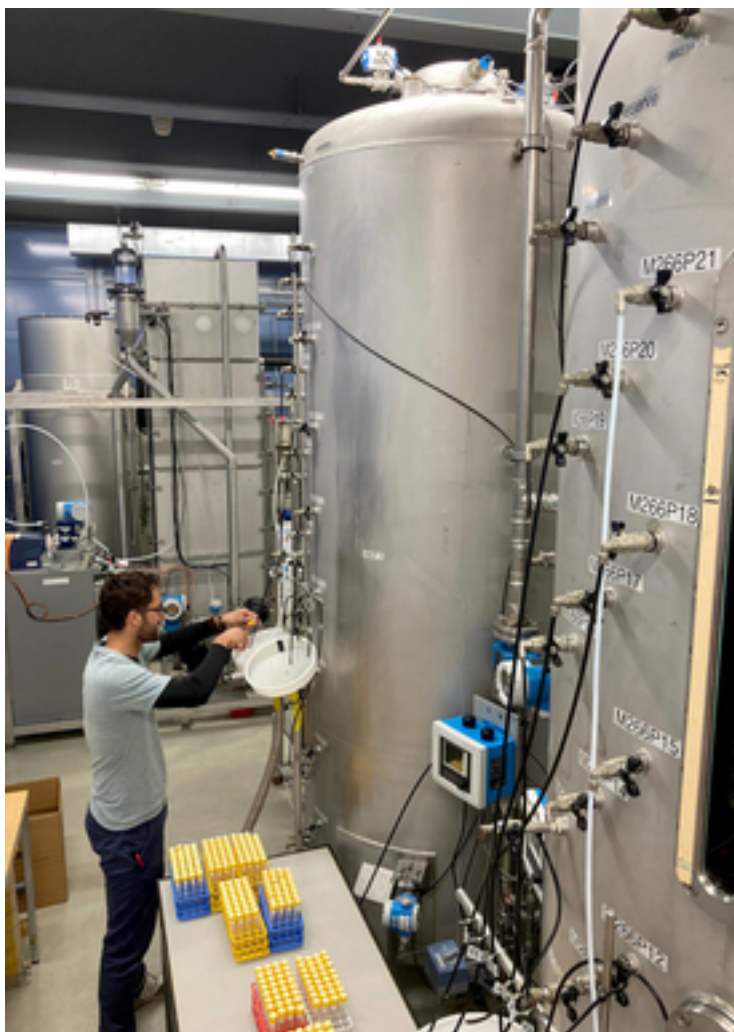
Colonne de filtration dans le laboratoire de l'Eawag (à gauche) et à l'échelle pilote dans la station de conditionnement de l'eau du lac du Service des Eaux de la ville de Zurich WVZ (à droite). (Photos: Eawag)
