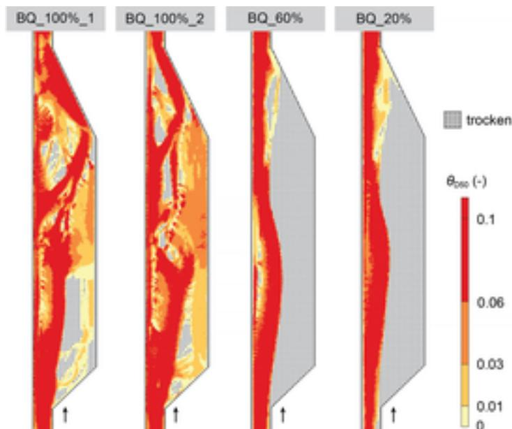
**Avec un déficit de charriage (BQ = 60 ou 20%), l'eau s'écoule majoritairement dans le bras principal et provoque de fortes contraintes de cisaillement (orange, rouge) tandis que la plaine alluviale reste principalement sèche. En revanche, un charriage équilibré (BQ = 100%, répété 2 fois) crée une mosaïque de zones à fortes contraintes de cisaillement et des zones de courant calme avec des contraintes de cisaillement moins importantes qui servent de refuges (graphique: VAW, EPF Zurich)**
