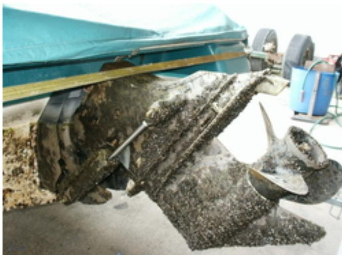
Presque toutes les eaux navigables de Suisse sont reliées entre elles par le transport terrestre des bateaux – les lignes les plus épaisses indiquent les voies les plus empruntées (à gauche). Moteur de bateau envahi par la moule zébrée (à droite).
