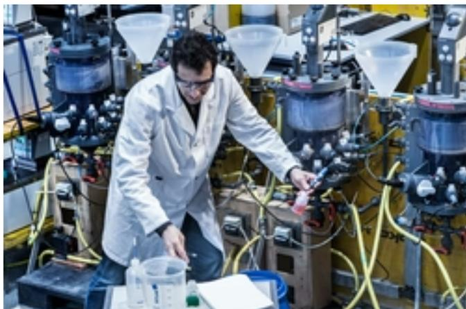
Adriano Joss dans le laboratoire de l’Eawag à Dübendorf. Dans le cadre de l’actuel projet de recherche de l’UE dénommé Athene, il exploite 12 mini stations d’épuration des eaux usées, à l’échelle d’un laboratoire, et étudie si et comment la traditionnelle étape d’épuration biologique des STEP pourrait être optimisée pour l’élimination de micropolluants.
