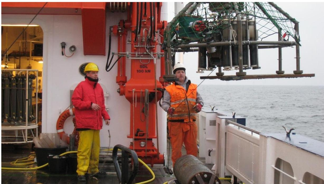
À l'aide d'un carottier multicore, les chercheurs ont obtenu des carottes de sédiments. (©: Ryan North, Eawag)
