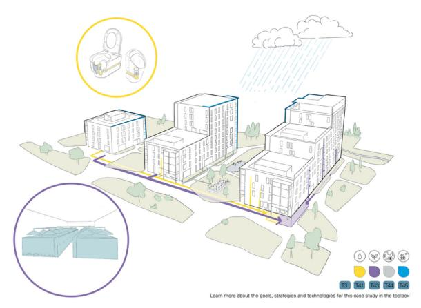
"La Bistoquette" est un lotissement coopératif à Genève avec des appartements pour 330 personnes. Les différents flux d'eaux usées sont séparés, traités dans la cave ou à l'extérieur et utilisés avec l'eau de pluie collectée pour les chasses d'eau. L'urine est collectée séparément pour produire un engrais liquide. (Photo : Rosanne Wielemaker, Eawag)
