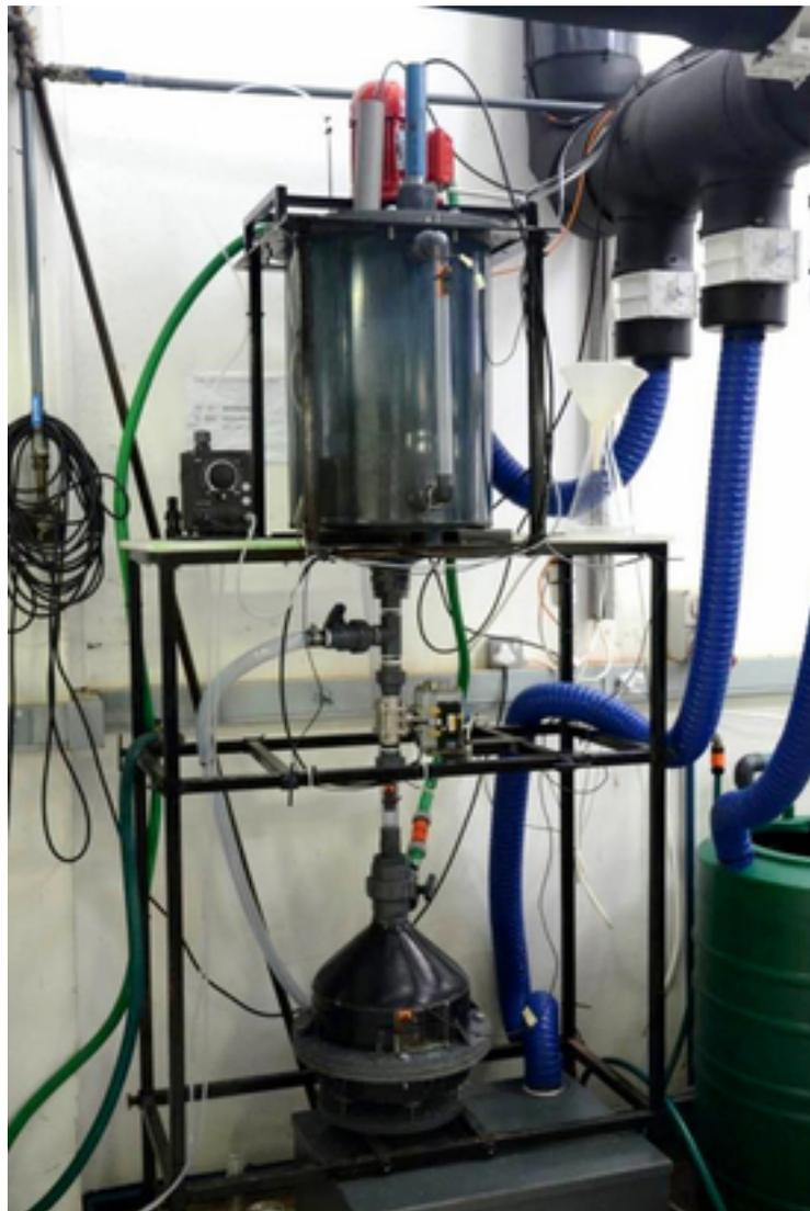
*Précipitation automatisée du minéral struvite à partir d'urine, fruit d'une coopération entre l'Eawag et l'université de KwaZuluNatal en Afrique du Sud. La struvite peut servir d'engrais phosphaté.*
