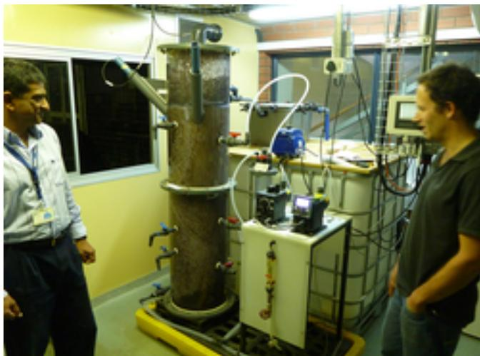
Fig. 6 : Pilote de traitement installé dans les locaux du service des eaux de Durban ouverts au public. Photo : Bastian Etter
