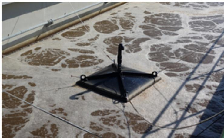
**Hotte de mesure des effluents gazeux en service à la STEP de Birs.**
