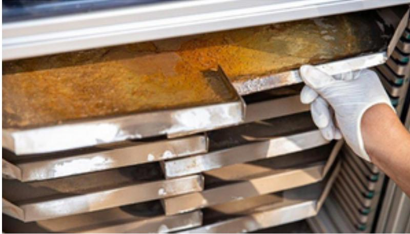
**L'évaporation de l'eau contenue dans l'urine réduit le volume initial de plus de 96 % et produit un engrais sec (Photo : Michel Riechmann, Eawag)**
