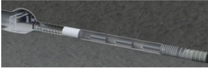
Conception de l'essai avec les conteneurs chauffés dans la galerie du Mont Terri. L'objectif est de montrer comment la chaleur de désintégration dégagée par les déchets radioactifs dans un dépôt en couches géologiques profondes agit à long terme sur la roche environnante. À cette fin, les scientifiques de la Nagra ont placé trois conteneurs de stockage final dans une galerie et les ont munis de corps de chauffe pour simuler le dégagement de chaleur des éléments combustibles usés. (Photo: Nagra)
