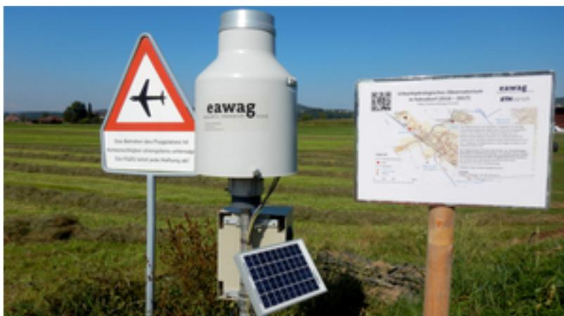
*Pluviomètre sur le terrain d'aviation de Speck
