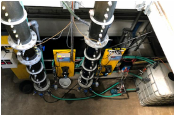
*Essais pilotes de filtration sur CAG à la STEP de Muri (photo : Eawag).*
